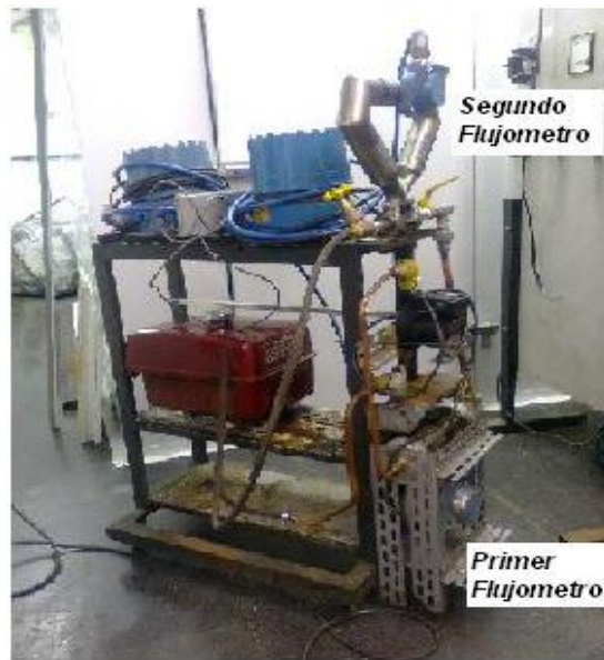
Figura 7. Sistema para medição de fluxo de combustível consumido pelo MCI.
